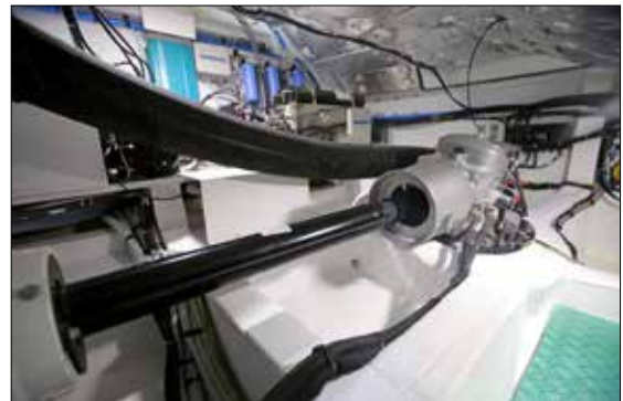
La position très reculée des pods nécessite l'utilisation d'arbres de transmission.
