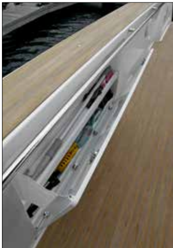
Le Pardo 50 ne manque pas de détails astucieux. Dans le pavois tribord, par exemple, on trouve une marche facilitant le débarquement ou un coffre de rangement très pratique.
